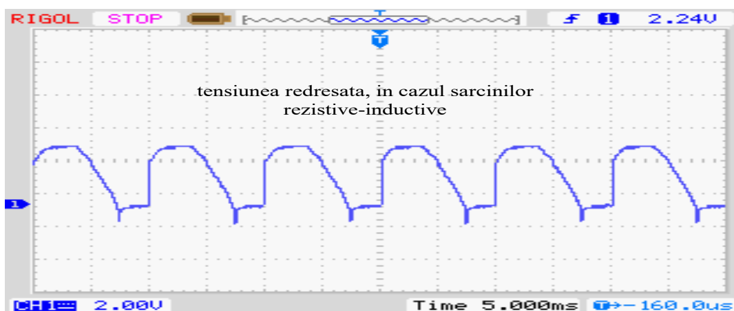
Fig. 6. Forme de undă aferente funcționării redresorului monofazat.
